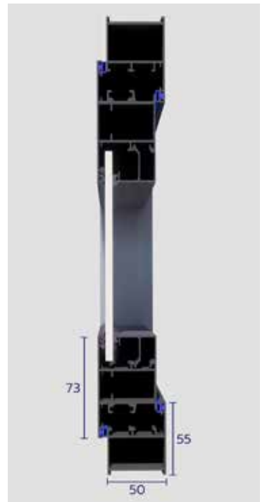
Section สำหรับทำบานเปิดตัดโค้ง
