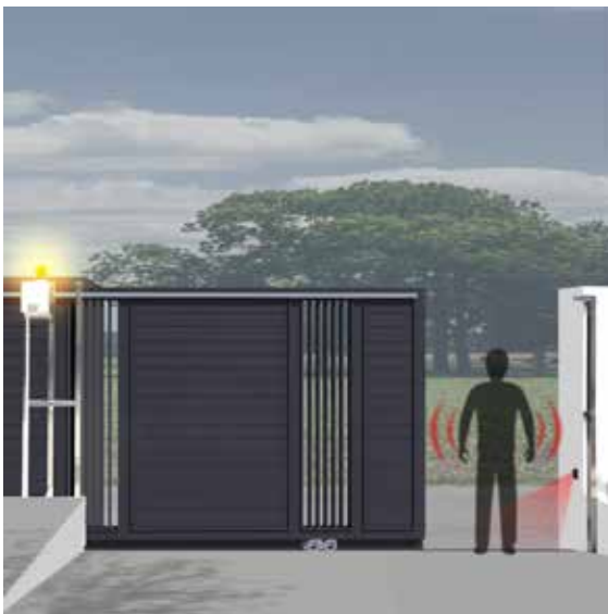
ระบบเซ็นเซอร์ป้องกันประตูหนีบ
